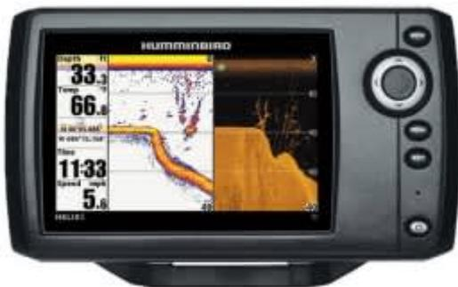
Der HELIX 5 DI G2 verfügt über ein brillantes Farbdisplay mit 256 Farben, 800x480 Bildpunkten, einer Displaygröße von 12,7cm bzw. 5" und Hintergrundbeleuchtung. Down Imaging und Dualbeam PLUS Echolot mit 4000 Watt PTP Ausgangsleistung. Maximieren Sie Ihre Erfahrungen mit dem Angel Humminbird Fischfinder HELIX 5 DI System.
