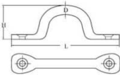
Diese Bugelösen aus rostfreiem Stahl helfen Ihnen, verschiedene Zubehörteile an Ihrem Boot zu befestigen.
